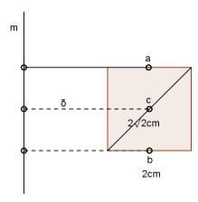
El área de la superficie generada por una diagonal es  $(2\sqrt{2} \times 2\pi\delta)$ cm<sup>2</sup> =  $20\sqrt{2}$  cm<sup>2</sup>.
