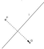
Para obtener el punto Q gráficamente, se traza la recta m perpendicular a I que pasa por P. Con centro en el punto O, intersección de m y I, se traza la circunferencia que pasa por P. El punto Q es el punto, distinto de P, en la intersección de m y la circunferencia.
