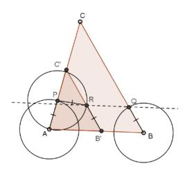
Con centro en A determinamos P sobre AC, con centro en B determinamos Q sobre BC. Una paralela a AB por el punto Q corta a la circunferencia con centro P en el punto R. Trazamos una paralela a BC por el punto R para determinar el triángulo AB'C' semejante a ABC.
