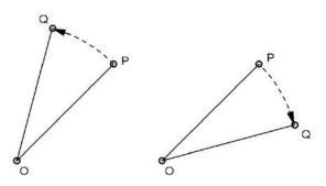
Para obtener el punto Q gráficamente, se dibuja el ángulo POR con el valor y la orientación de  $\alpha$  y se toma la intersección entre la semirrecta OR y la circunferencia con centro O que pasa por P.
