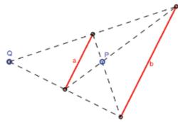
Uniendo con rectas los vértices de los segmentos paralelos *a y b*, encontramos dos puntos *P y Q*, que sirven como centros de homotecias que transforman un segmento en el otro. Este hecho puede justificarse usando el Teorema de Thales y los detalles se dejan para los desarrolle el lector. ¿En qué situación habrá una sola homotecia? ¿Cuál será su razón?
